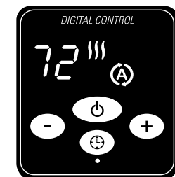
La pantalla refleja la función de Control Automático de Temperatura
